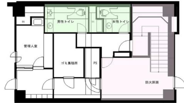
避難階段に隣接する形で男女トイレが設けられていた。
